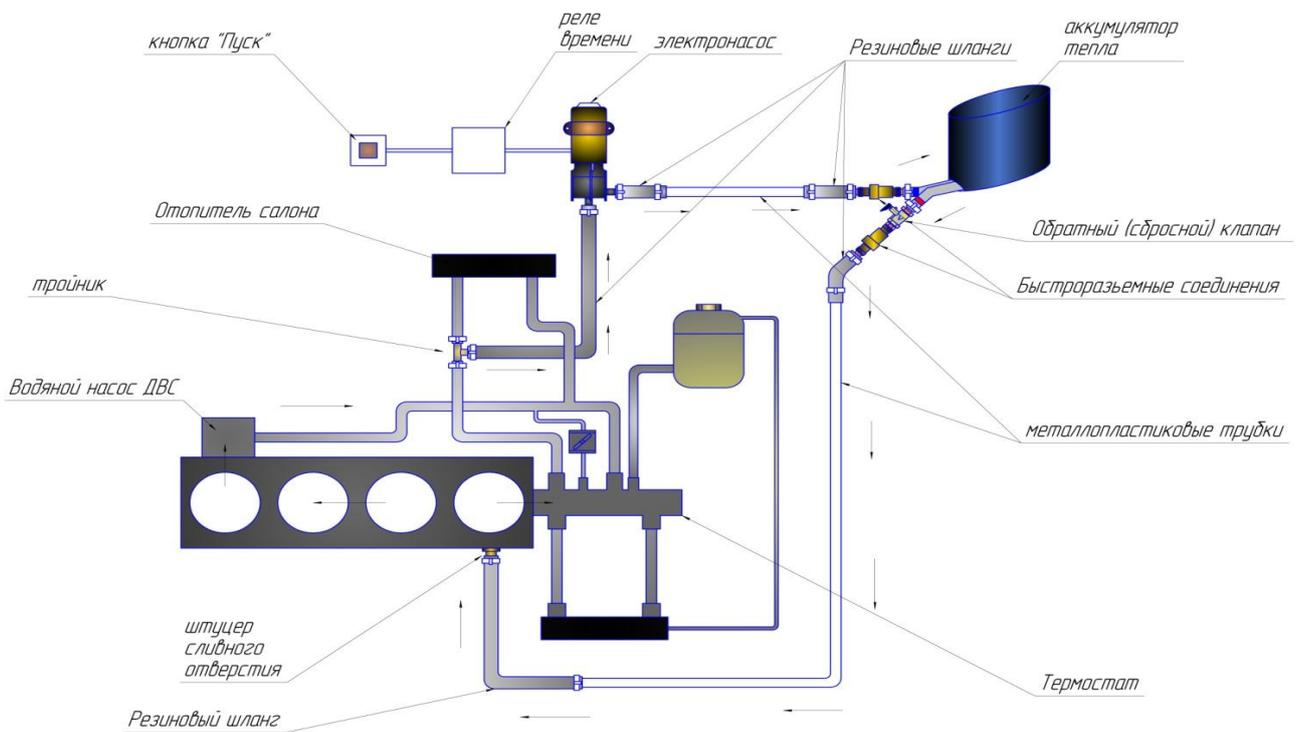
Рис.2 Рекомендованная гидравлическая схема соединений для отечественных автомобилей и большинства иномарок через штуцер сливного отверстия в блоке цилиндров для подогреваемых Аккумуляторов тепла АТ – 6 МП.
