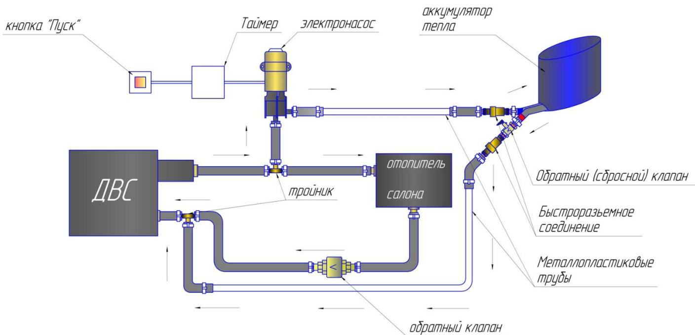
Рис 4. Рекомендованная гидравлическая схема соединений для импортных автомобилей подогреваемых Аккумуляторов тепла АТ – 6 МП.
