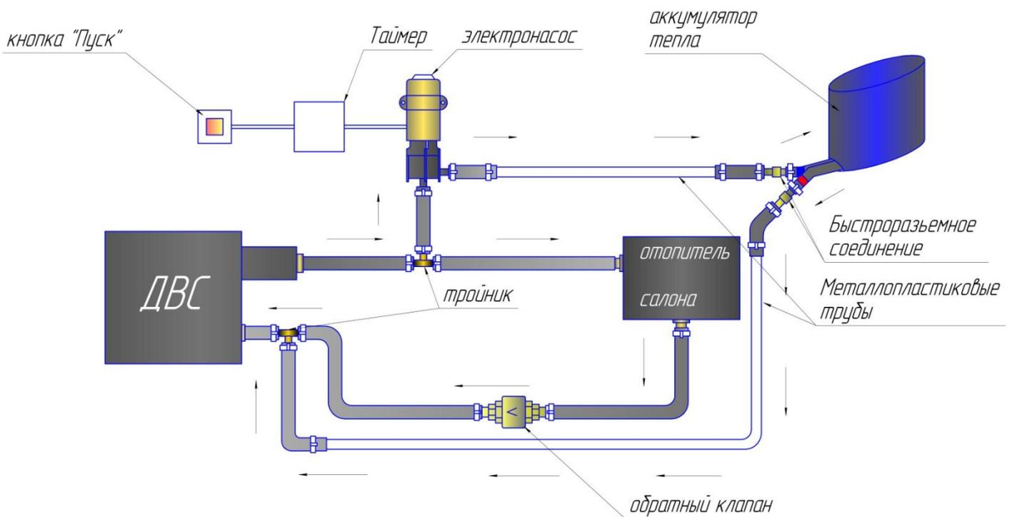
Рис.3 Рекомендованная гидравлическая схема соединений для большинства импортных автомобилей
